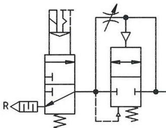
Belüftung der Anlage über Drosselstellung
